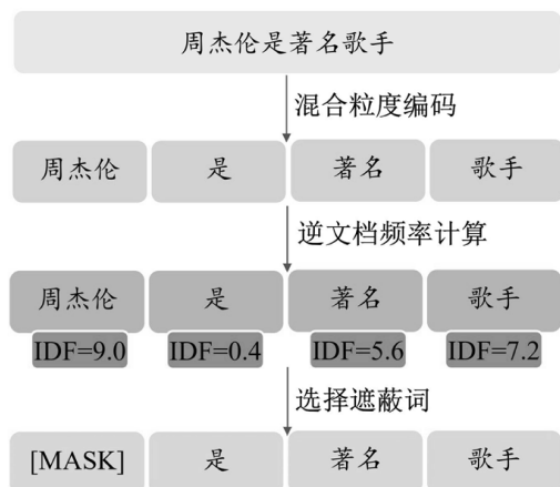
图2 混合粒度编码的模型 使用 IDF 遮蔽训练时的数据处理流程
